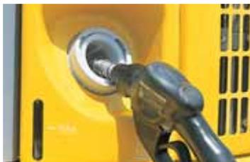
Großer Einfüllstutzen mit Sieb
