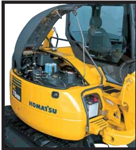
Hydraulikölfilter mit langer Lebensdauer (mit Ecowhite-Filterelement)
