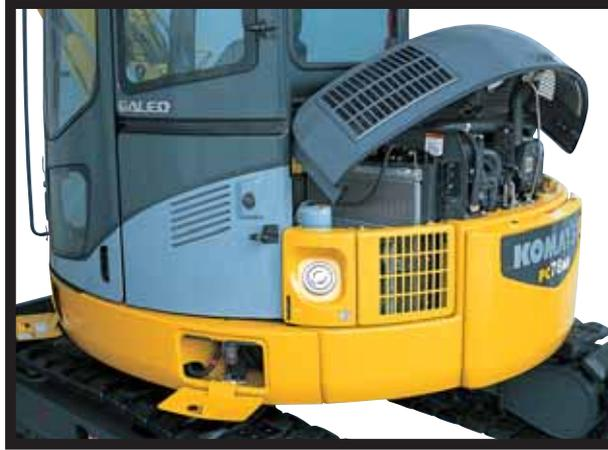
Leicht zu wechselndes Luftfilterelement
