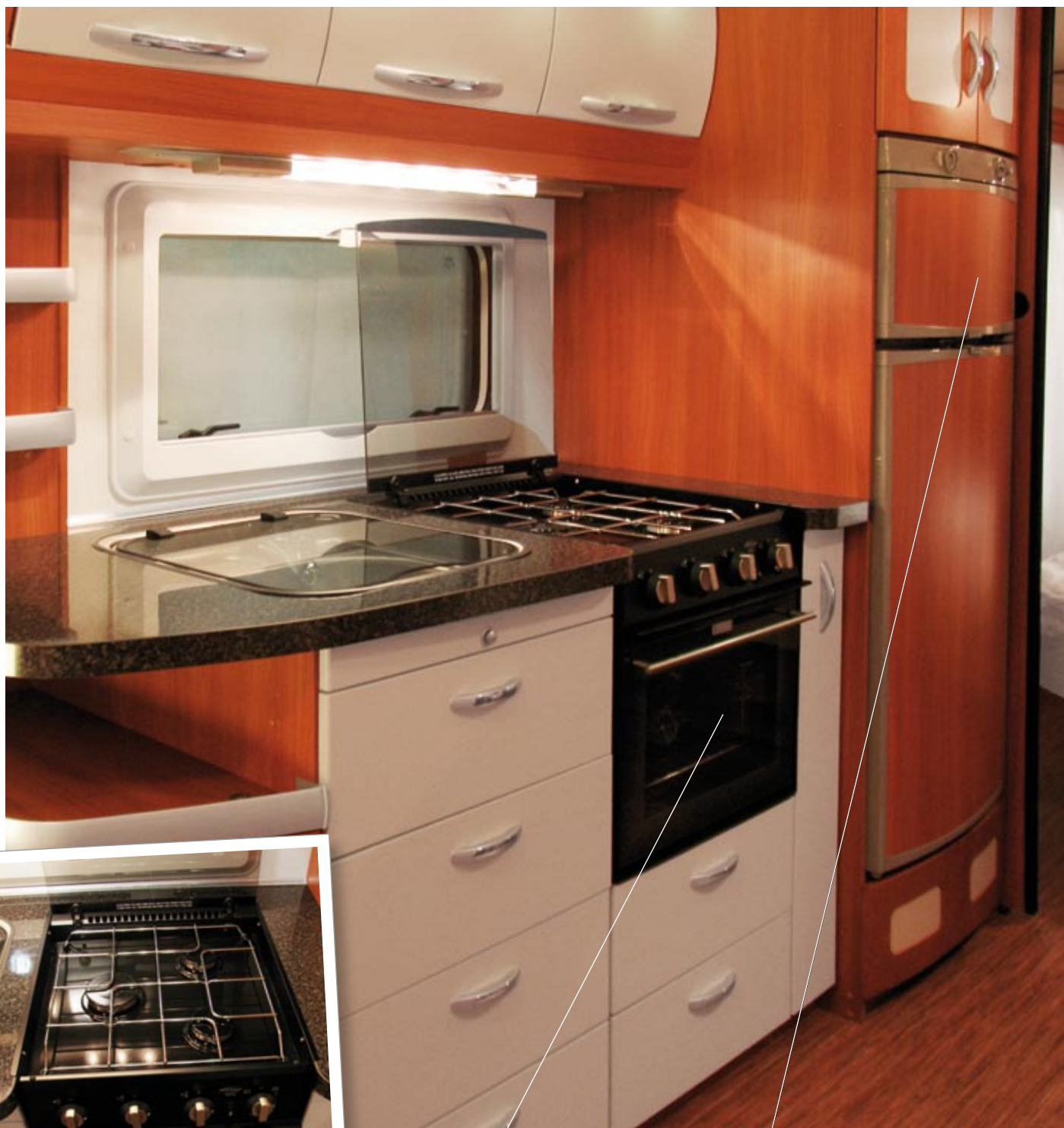
Spinflow-ugn med elektrisk tändning inkl. extra spotlights som arbetsbelysning.
