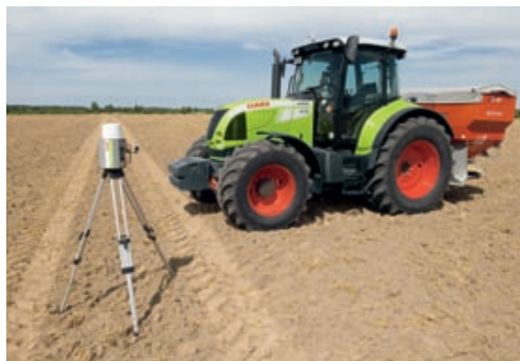
Der GPS-Empfänger des BASELINE HD Systems. Dazu gehört ein zusätzlicher Funk-Empfänger für das Referenzsignal.
