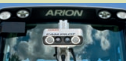
Die CAM PILOT Kamera im Frontanbau.
