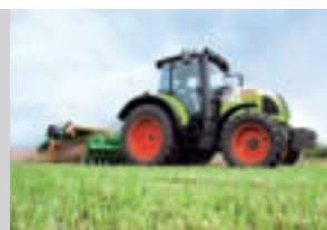
CPM Boost: nutzbar bei Zugarbeiten über 6 km/h.
