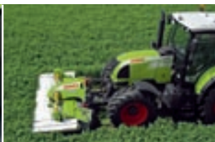
Fronthubwerk mit externer Bedienung.
