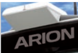
Der OMNISTAR HP Empfänger für GPS-Signal und GPS-Referenzsignal.
